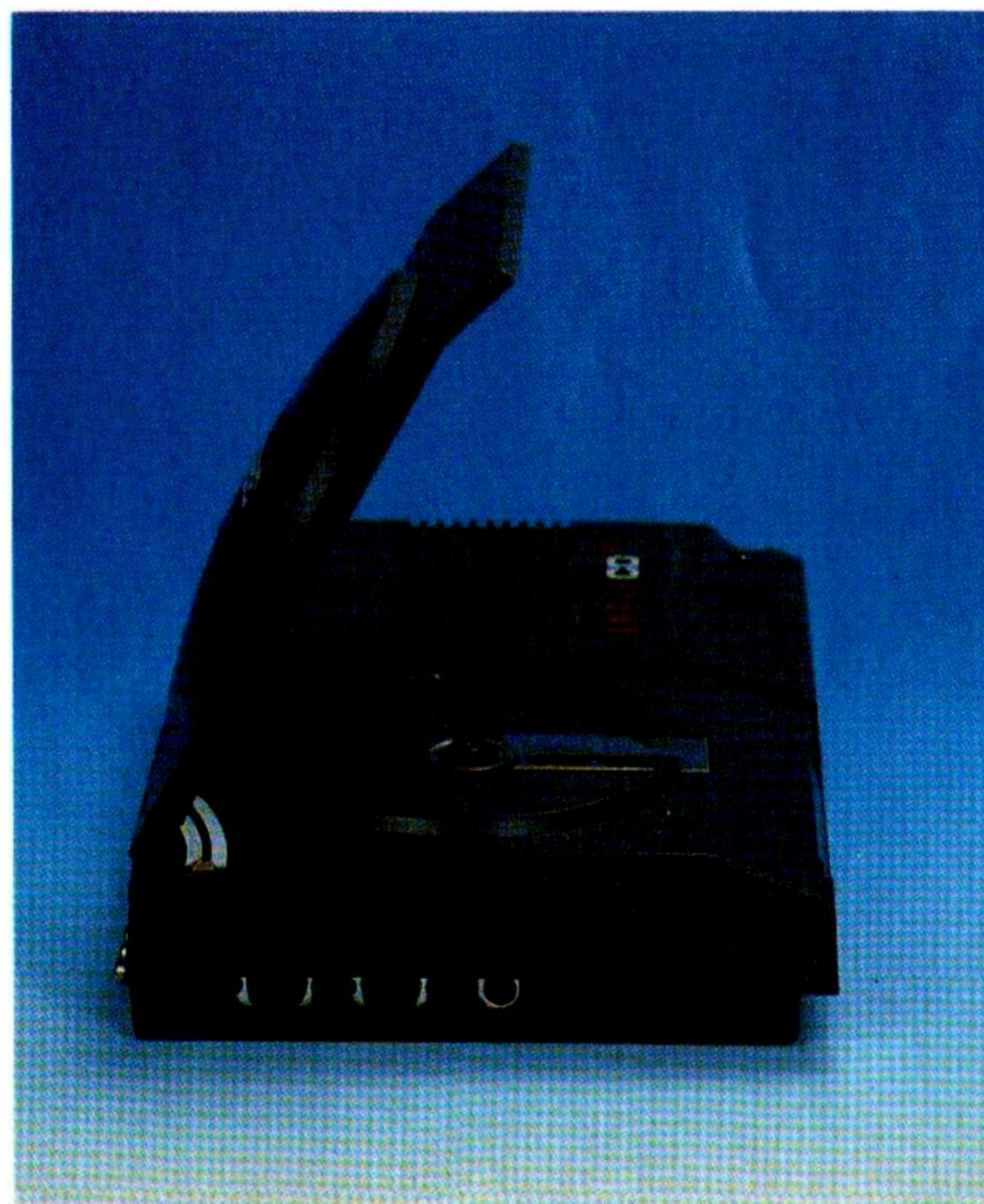
I connettori laterali del CD32: porte joystick e Aux per tastiera.
